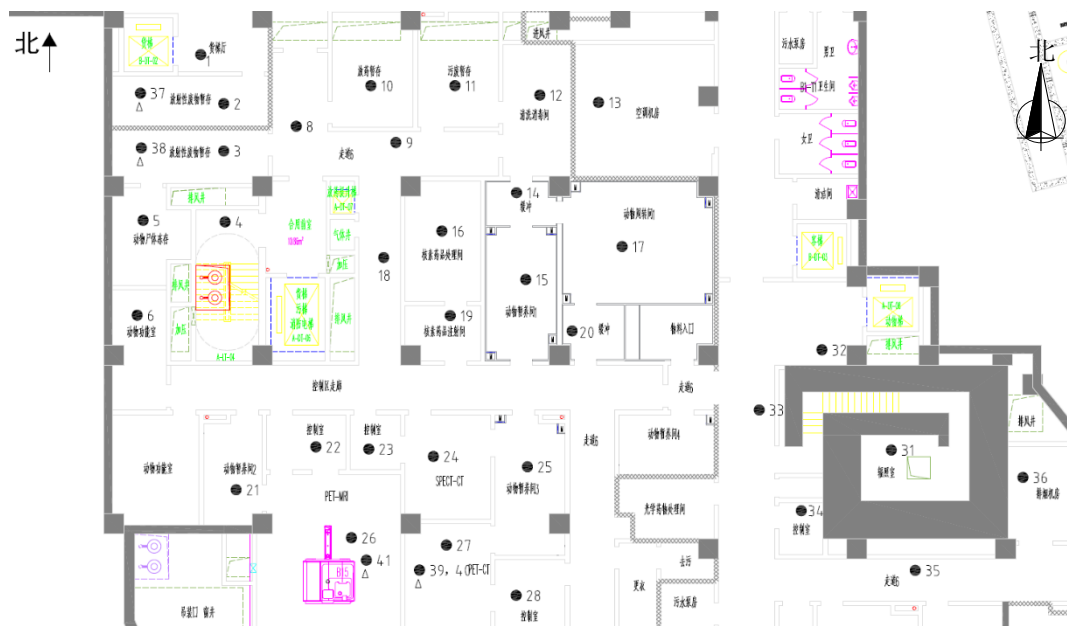
图 8.1-1 地下一层中部检测布点示意图
